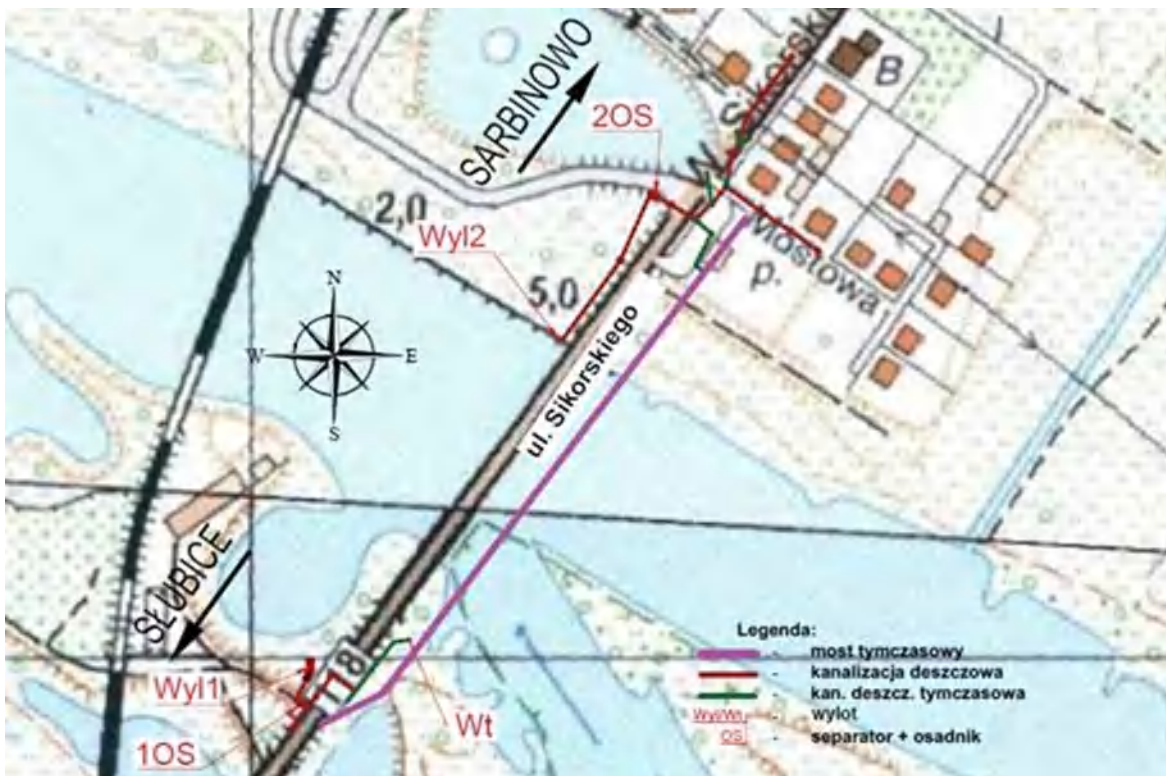
Ryc. 1 Schemat sieci kanalizacji deszczowej docelowej i tymczasowej
